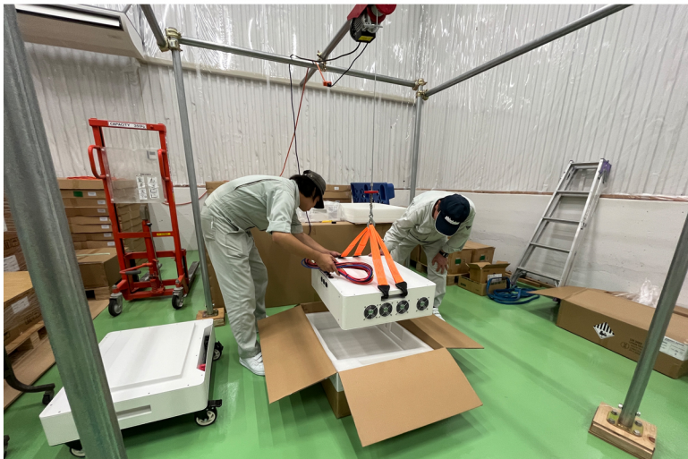
製品取り出し風景 電動ウインチ使用し持ち上げます。
